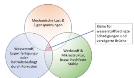
Abb. 2: Allgemeine Einflussfaktoren zu wasserstoffbedingten Schädigungen
